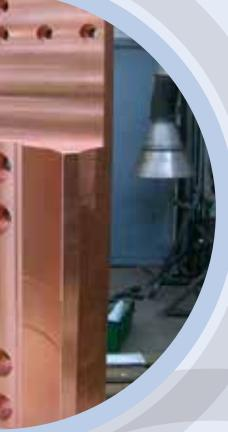
Plaque de contact en cuivre forgé pour fours métallurgiques à poche (LF) / Placa de contacto de cobre forjado para hornos de cuchara (LF)
